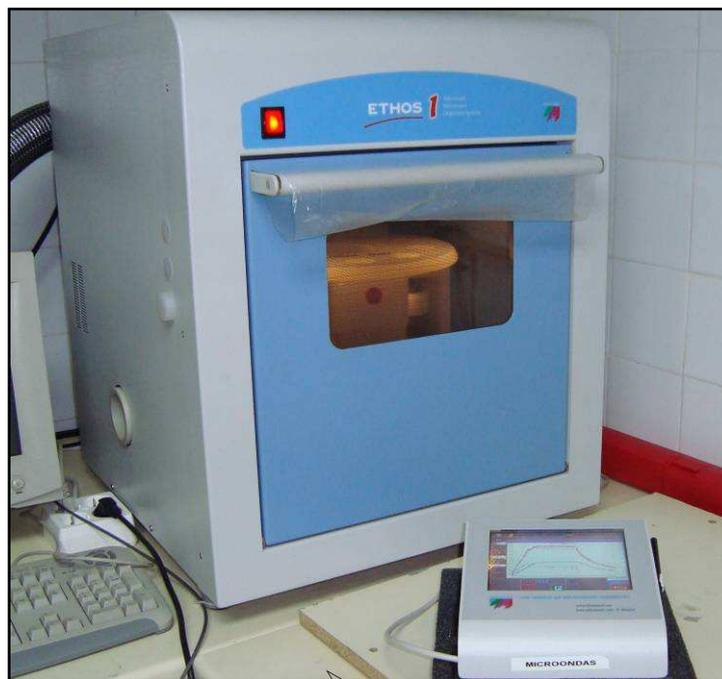
**Figura 3. . Microondas empleado en la digestión**
