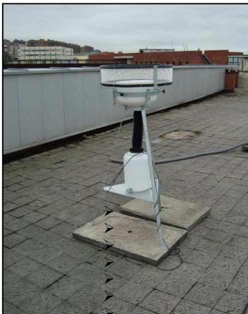
**Figura 2. Captador global ubicado en el tejado de la ETSIYT**
